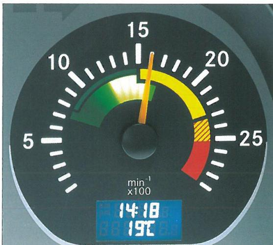
Drehzahlmesser mit variabler Drehzahlbereichsanzeige (z.B. bei Mercedes und MAN) lösen das Dilemma: Hellgrüne Leuchtdioden signalisieren den aktuell wirtschaftlichsten Drehzahlbereich. Beim Betätigen der Motorbremse verschieben sie sich zum Drehzahlbereich mit der besten Motorbremswirkung.
